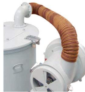
System zwrotnego wykorzystania gorącego powietrza
